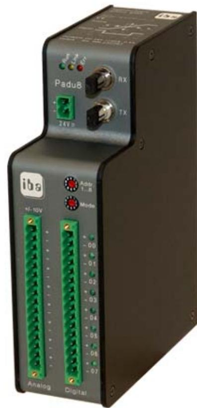
Los dispositivos ibaPADU cuentan con un conector RJ11 que permite conectar una computadora portátil usando la tarjeta **ibaCOM-PCMCIA-F**. Los datos son transmitidos simultáneamente a través de la fibra óptica y a través del cable para la interfase PCMCIA lo que permite muestrear en ambas interfases sin perturbar la medición de cualquiera de ellas.
