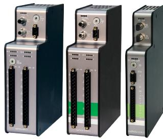
Серия ibaPADU (Parallel Analog Digital Unit) позволяет осуществлять высокоточный сбор аналоговых и цифровых сигналов и записывать их при помощи системы сбора данных ibaPDA. Быстрое и синхронное считывание всех сигналов позволяет проводить детальный анализ всех технологических процессов.
