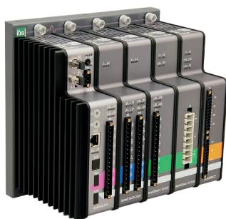
Модульная система iba собирает и обрабатывает измеренные сигналы, а благодаря соответствующим модулям вывода сигналов подходит для управления и регулирования. Решающим преимуществом системы является свободно формируемая концепция: в объединительную панель сшиной на задней стенке можно вставить центральный блок и до четырех дополнительных модулей ввода/вывода. В зависимости от области применения можно выбрать специально подобранный центральный блок.
